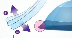
30 µm per step Minus (-) steepens SLZ angle. Plus (+) flattens SLZ curve.
